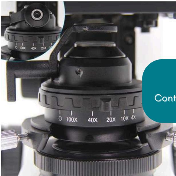
Condensador basculante, N.A.0.9/0.13,
